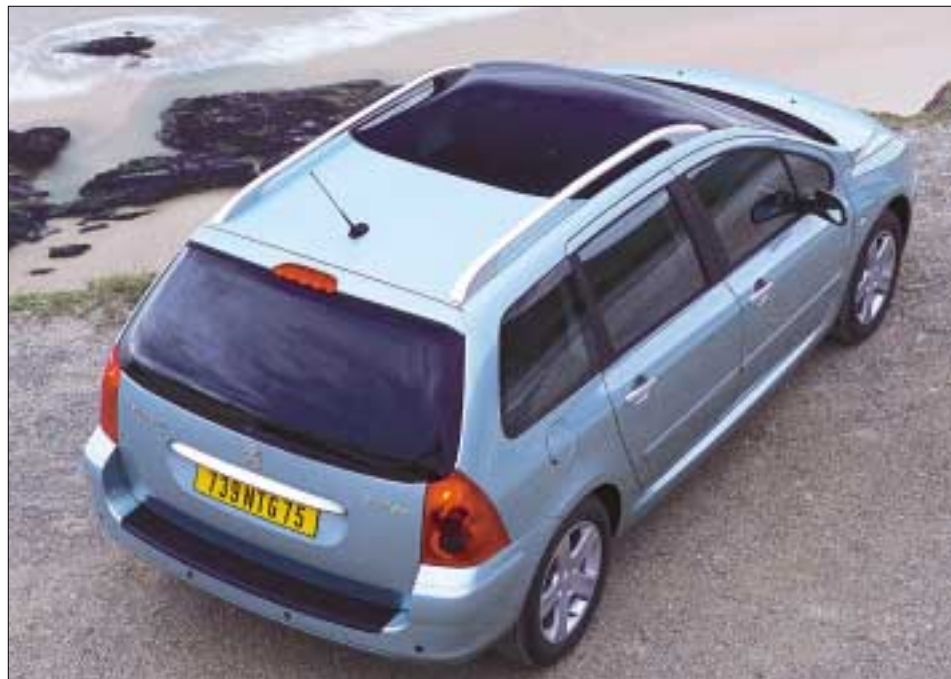
Meira enn helvtin av takinum er laminerað glas. Um sólin er ov sterk, kunnu elektrisku sölgaðinurnar koyrast fyri, so ljósið ikki kemur inn tann vegin
