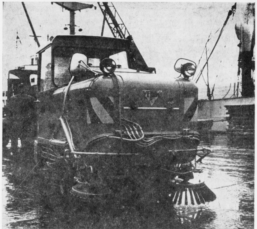
Verro-City sópmaskinan arbeiðir eftir Verro prinsippinum, t. v. s. at sópingin er luftgrivis (pneumatisk). Hon sópar 2,5 — 12 km 2 /tim, ella upp til 20.000 m 2 /tim. Samlaða vegalengdin í Havn er ca. 50 km, hetta svarar til ca. 200.000 m 2 . Roknast kann tí við, at sópmaskinan rokkur um allan býn 2 ferðir um vikuna.
