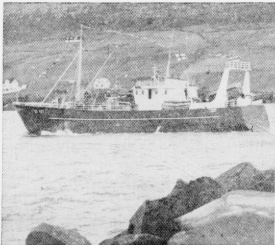
Suðuroyarskipið »Nýborg« hjá pf. Nýborg í Lopra. Skipið er bygt á Tórshavnar Skipasmiðju. Skipið hevur motor uppá 15 hk, harumframt 2 Mercedes Benz hjálpimotorar uppá 150 hk hvør. Øll nýmótans navigatiónstól eru á brúnni. »Nýborg« er útgjørt við kraftblokk, men kanu eisini nýtast til troling.
