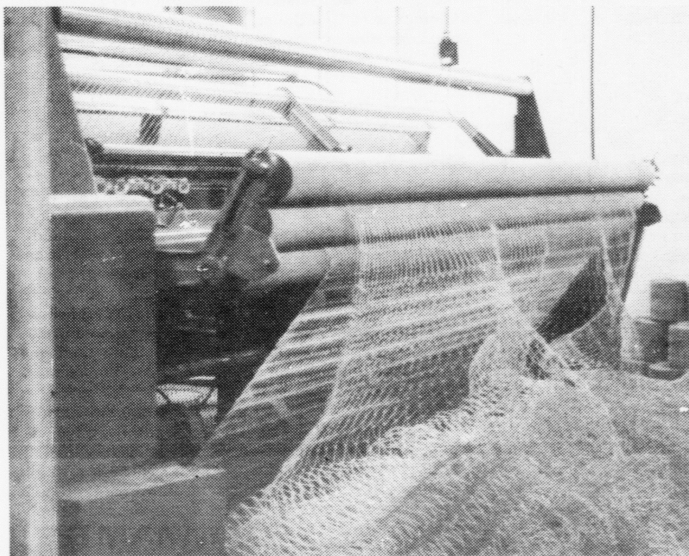
Á Heiða Netavirki í Runavík. Knýtmaskinan knýtur net til trol
