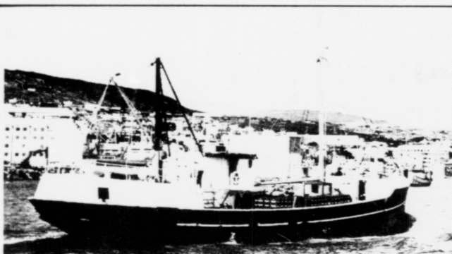
»FØROYA BJØR«, XPXO, Klakksvík, T/F Føroya Bjør, Klakksvík, Einar Waag, Klakksvík, torlastskib — singledækker, J. Ring Andersen, Svendborg 1936, uklasset, 71 nrt, 174 brt, 200 tdw, 30,5 m.oa., 7,49 m, 3,96 m, 1 luge 3,9 x 2,5 m, B&W/Alpha 1957, 420/309 hk/kw, ex »Vidøy«.
