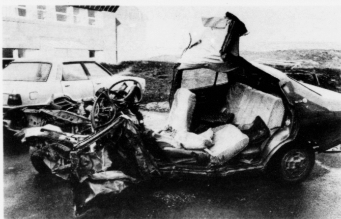
Ein sprunga hevur verið í rammuni, sum heldur motorinum. Ti fór motorurin aftur-ígjøgnum og klemdi bilforaran, sum fekk álvarsliga skaða. Bilurin er gamal
