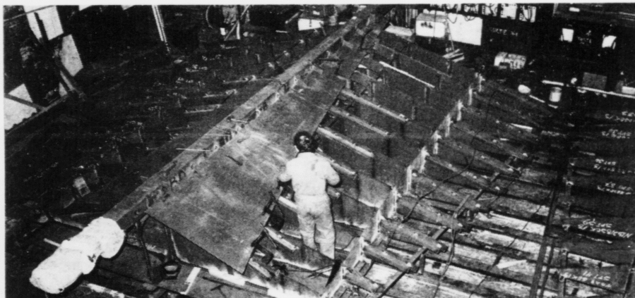
Sveisararnir í byggihellini á Tórshavnar skipasmiðju kunnu nú aftur fara í gongd eftir ein steðg. Her eru teir í ferð við at rigga til botnsektiónirnar til báðar nýggju dalstrolararnar
