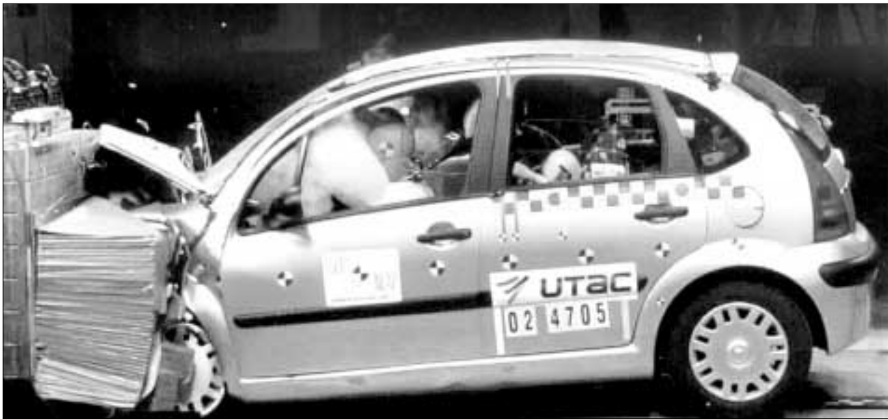
Soleiðis verða nógvir nýggir bilar testaðir. Her er tað ársins bilur í Danmark 2003, Citroën C3, sum verður kroystur saman framman undir eini EuroNCAP test. Sum tað sæst á myndini, stóð bilurin seg væl
