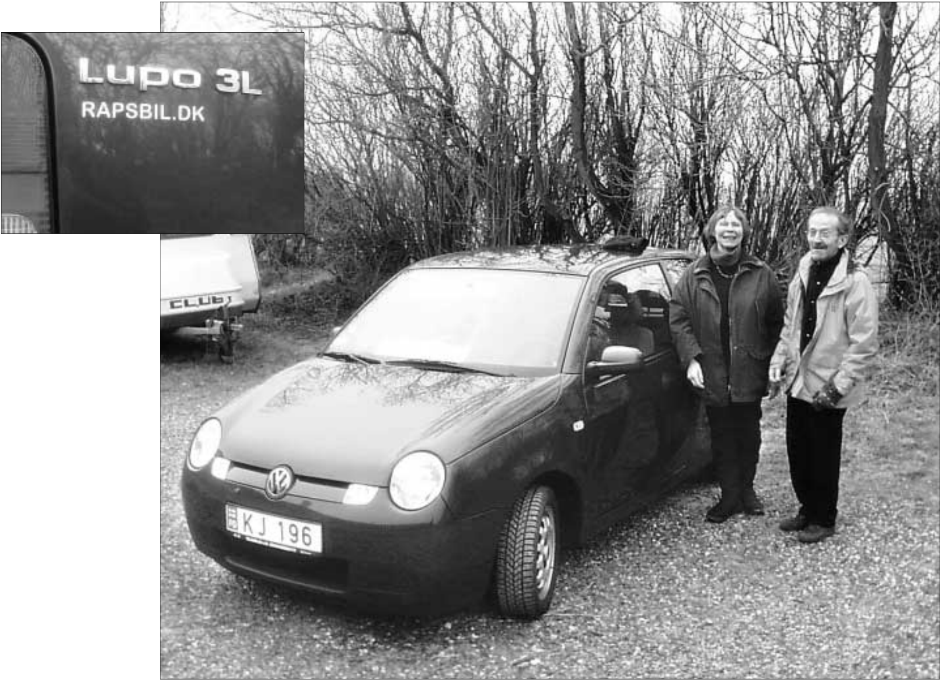
Jórun og Erling Simonsen við VW Lupo bilinum sum nú koyrir uppá rapsolju istaðin fyri dieselolju. "Nordvestjysk Folkecenter for Planteolieteknologi" hava staðið fyri umbyggingini av bilinum, sum verður í Føroyum mánadagin
