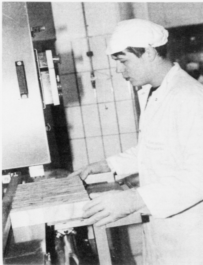
Á góðskingardeildini á Bacalao. Blokkurin er uppsagður í smærri stykki, sum verða pakkað beinleiðis til brúkaran. Mynd kalmar
