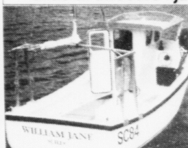
»KINGFISHER K20«. Longd 6,02 m, breidd 2,40 m, djup/stingur 0,66 m, lunningsh 0,76 m, standihædd í húsi 1,95 m. Lættur at gera lidnan úr hálv-fabrikata.
