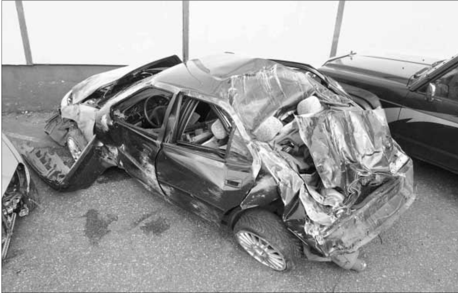
Nýggir bilar eru gjørdir soleiðis at teir geva eftir aftan og framman, meðan kabinan ofta er púra heil
