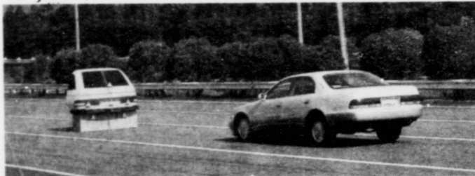
A myndini omanfyri hevur førarin spíðaran í botni, men bilurin steðgar kortini. Á niðaru myndini sæst gongufólka-airbag'in, ið blæsist upp úr motorhjálminum, tá kúfangarin nertir við fótgangara.
