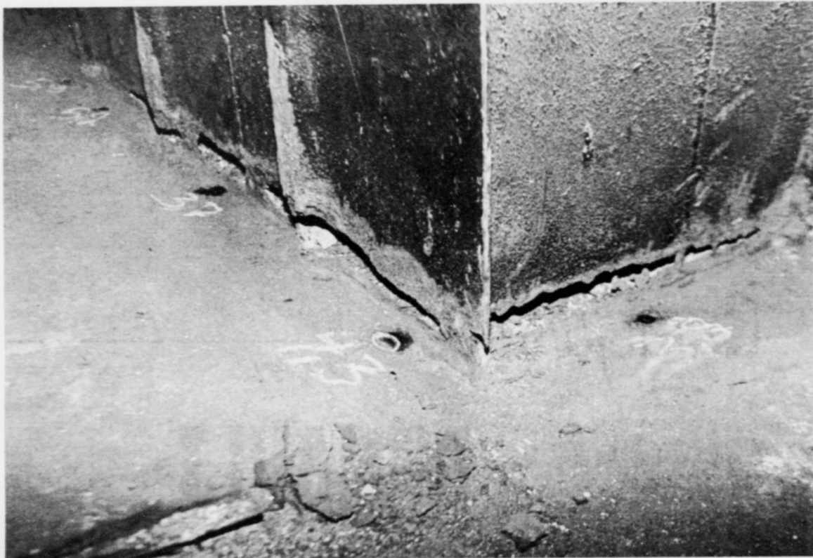
So illa er tært, at skottið er nærum leyst frá dekkinum. Hetta er í fleiri støðum á nýggja vaktarskipinum, Nólsoyar Páll, sum nú er á beding á Skála
