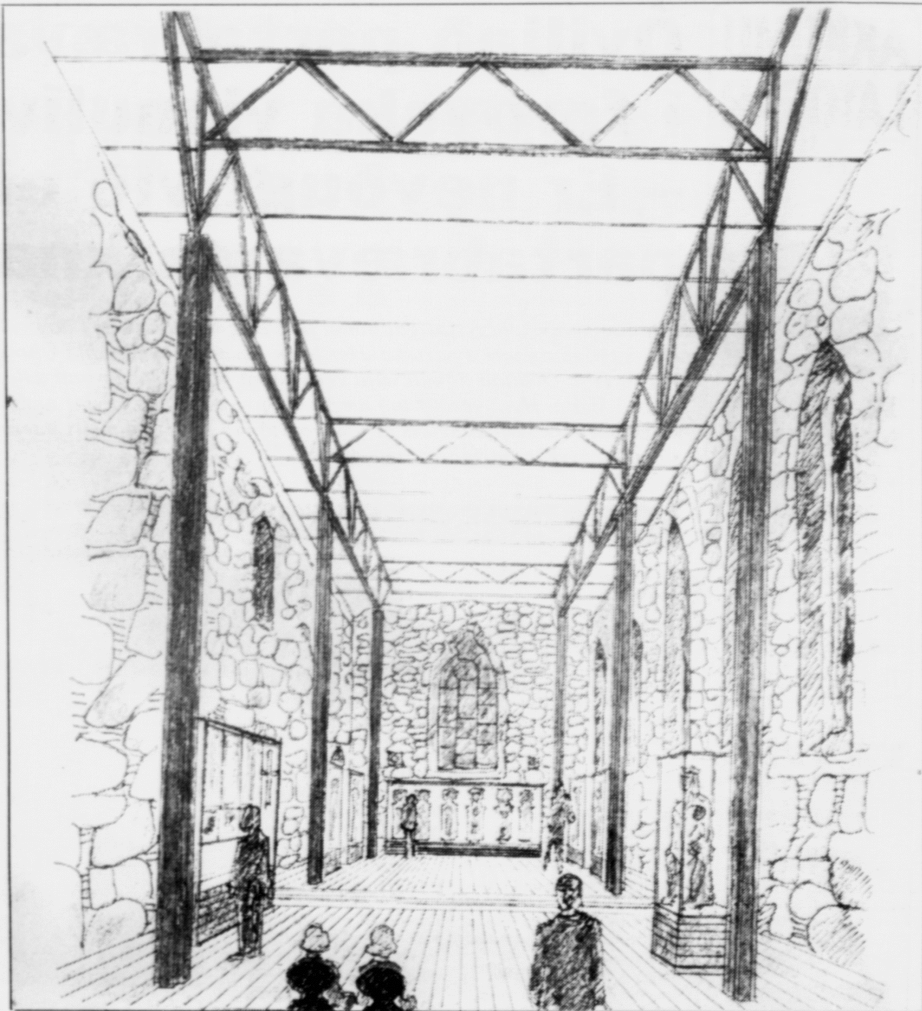
Soleiðis sigur verkætlanin at innihøvrið í múrinum kemur at siggja út. Stálsúlurnar siggjast í síðunum og innast siggjast nakrir av kirkjubóstólunum
