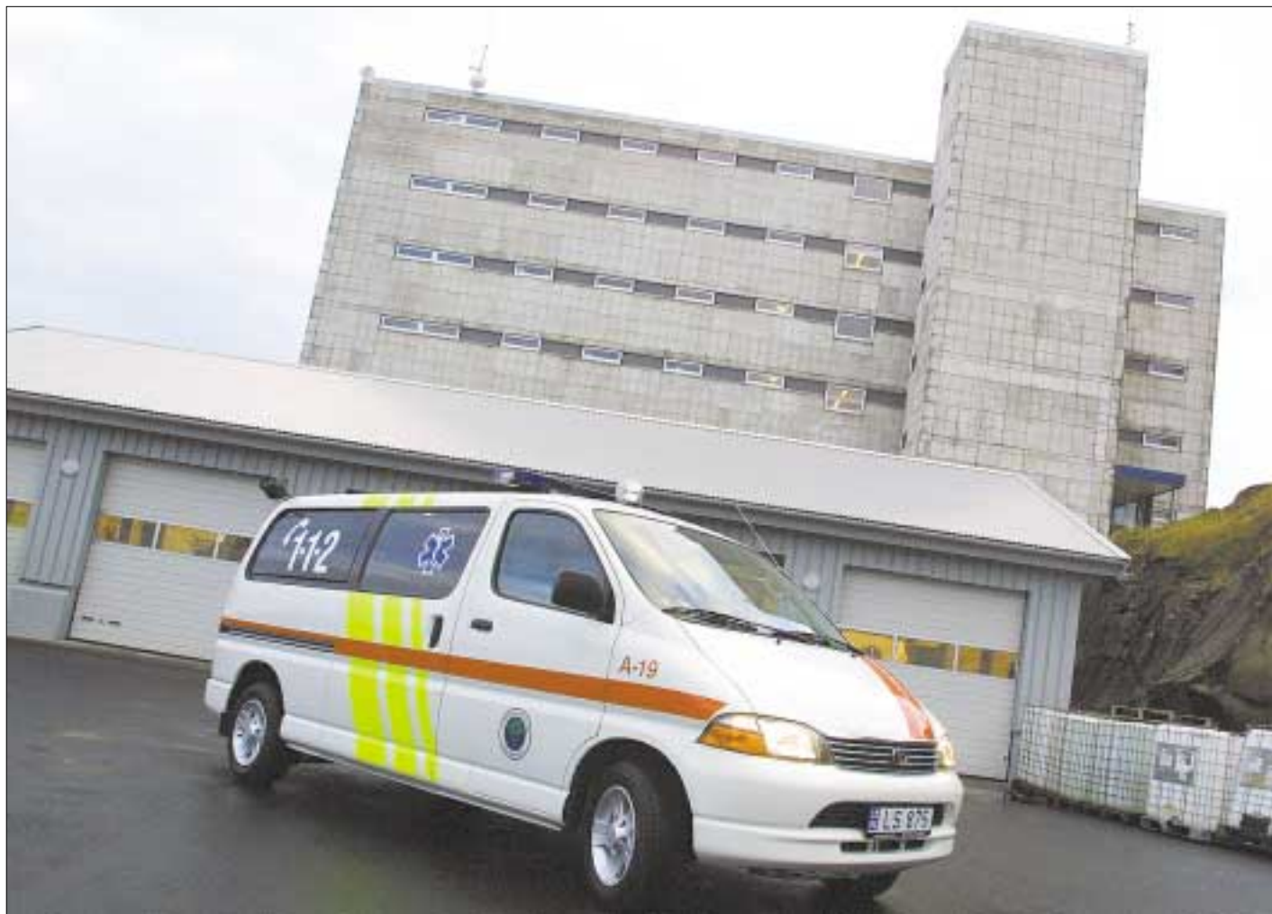
Hesin Toyota Hiace við 2,7 litur bensinmotori og 143 hk er uppbygður til sjúkrabil á Landssjúkrahúsinum
