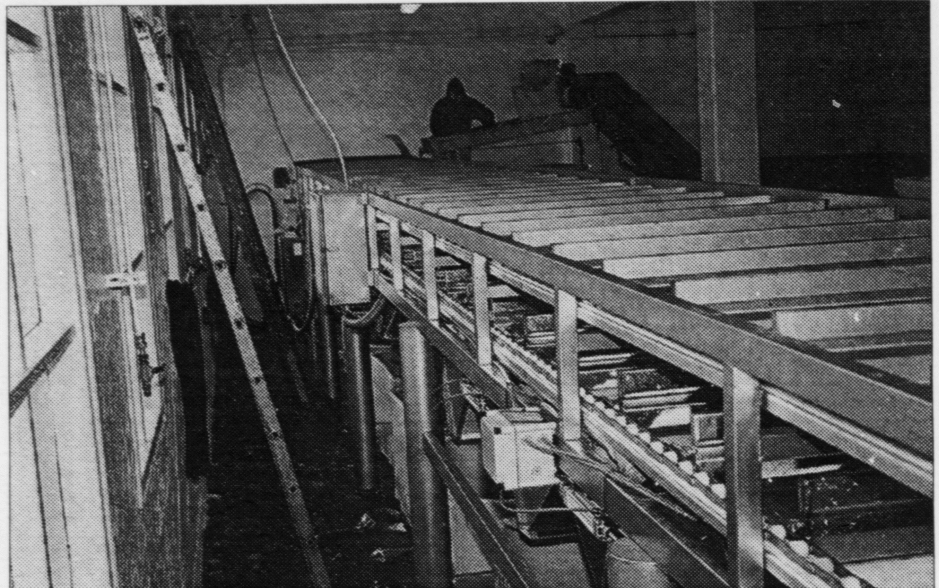
Nýggi rávørflokkarin, sum hann stendur í høluni hjá Føroya Fiskavirking í Havn. Fiskurin endar í kassunum, sum standa inni undir flokkanum. Hesin flokkarin ger, at fiskurin verður bólkaður í »rættar« støddir beinanvegin, og tað gevur Fiskavirking møguleika at tilrættsleggja framleiðsluna beinanvegin
