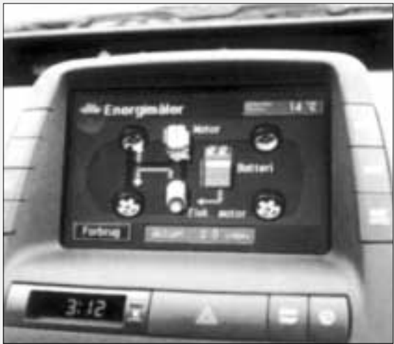
Á einum skíggja í miðjuni á instrumentborðinum kann bílførarin og tey ferðandi í bílinum fylgja við hvat hendir í motorrúminum, hvør motorur er í drift o.a.
