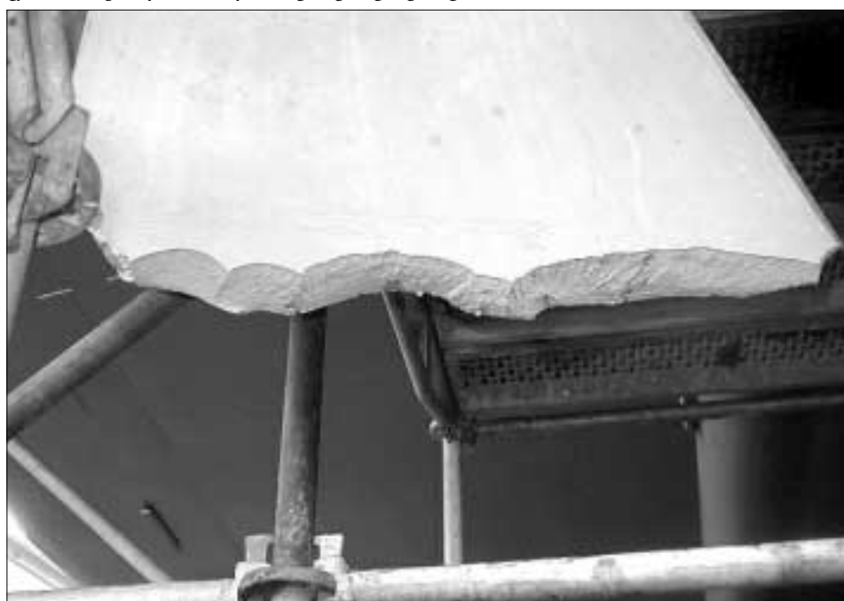
Eitt av skaddu skrávubløðunum á Norrönu. Bakborðsskrávan fekk stóran skaða, tá skipið bar við land.
