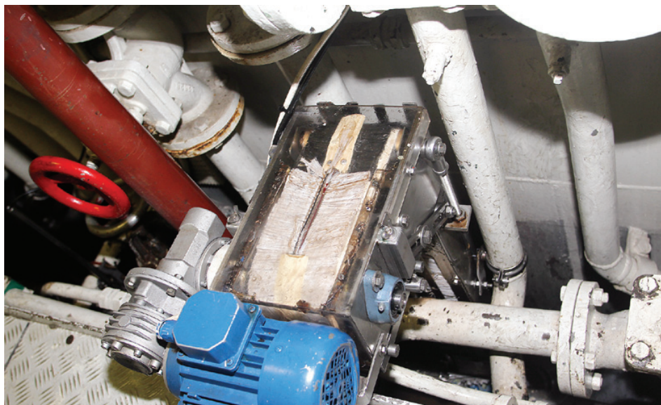
Oljuútskiljarin virkar sum eitt transportband, sum koyrir spakuliga alla tíðina
