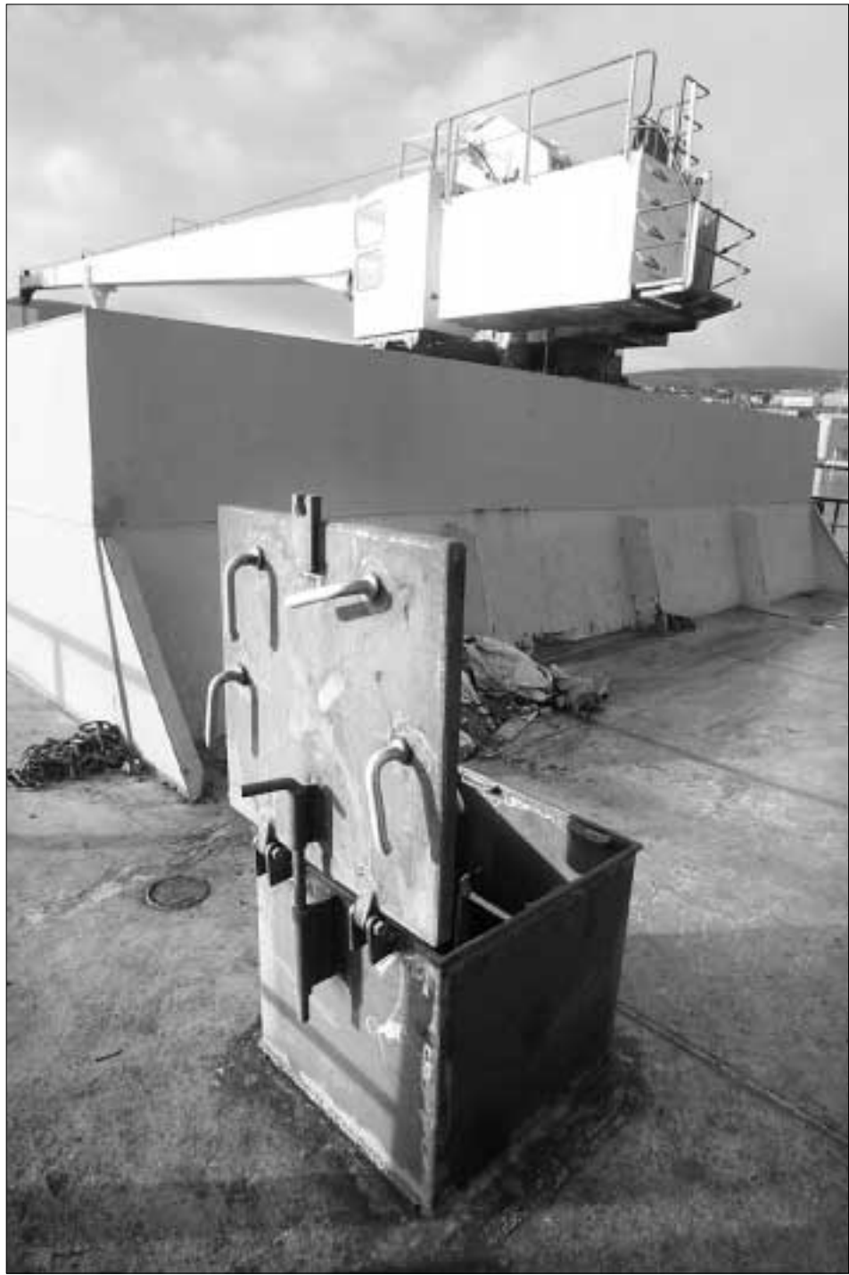
Bingjurnar skræddu kappan oman av dekkinum, so sjógvur fossaði niður. Seinni tettu somu bingjur holið aftur. Fólk frá Tórshavnar Skipasmiðju hevir nú gjørt nýggjan kappa
