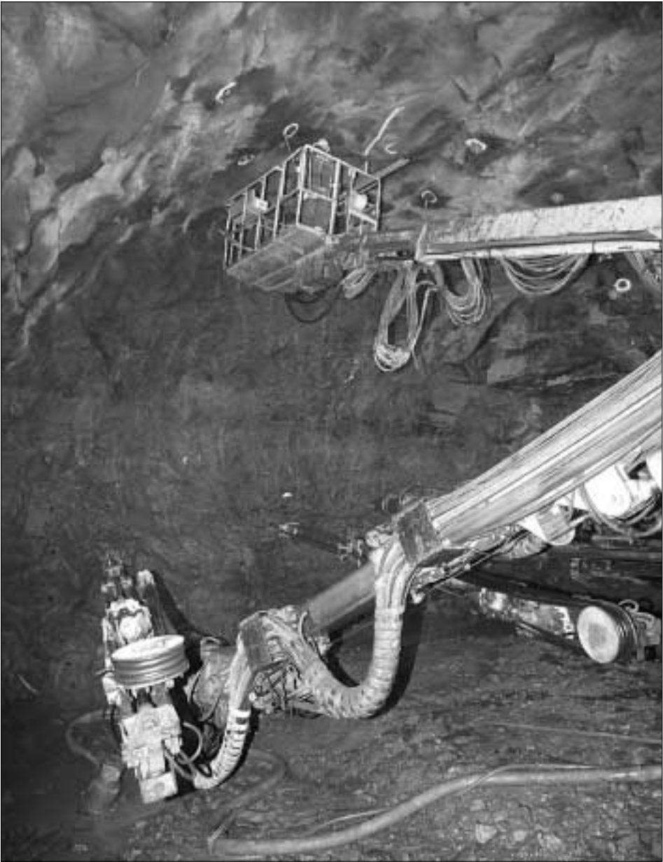
Útgerðin er nógv broytt. Í 1978 varð luftboringin skift út við hydrauliska og dátustýrda boring
