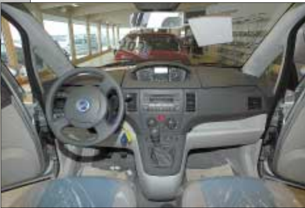
Instrumentborðið er av nýggja stílinum við øllum instrumentunum saman í miðjuni
