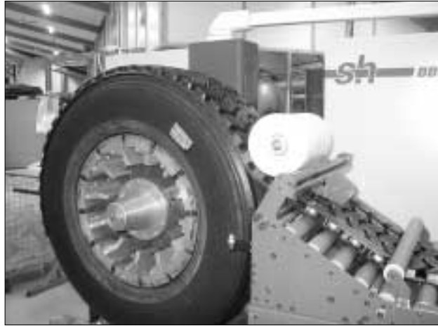
Nýggjur slitbani verður lagdur á eitt lastbiladekk. Maskinurnar eru ógvuliga neyvar og slitbanin passar perfekt Mynd: Magnus Gunnarsson
