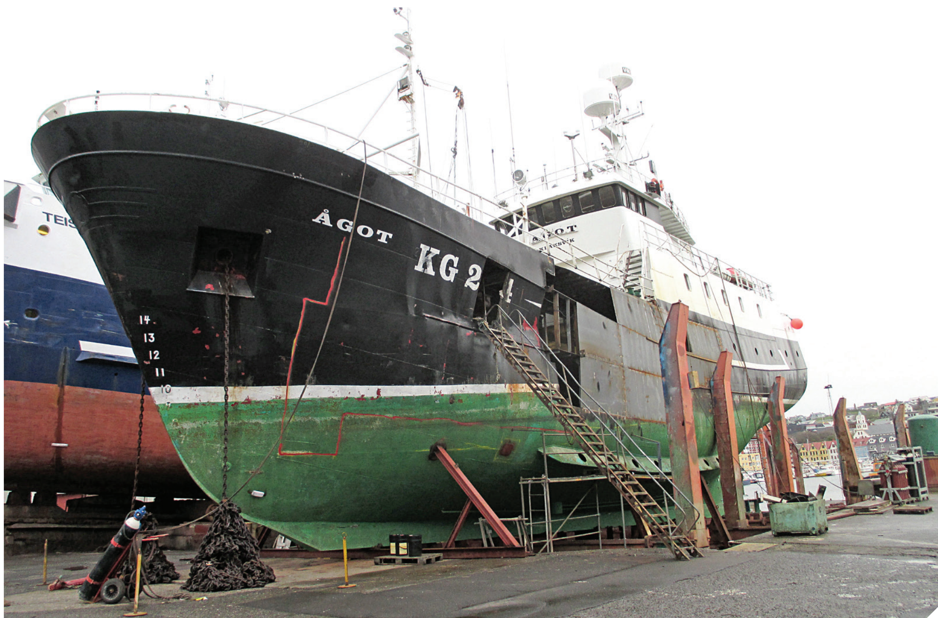
Skaðin, sum garnaskipið Ágot fekk, tá Slættaberg rendi bulbustevnið inn í skipssiðuna, verður umvældur á skipasmiðjuni Mest í Havn
