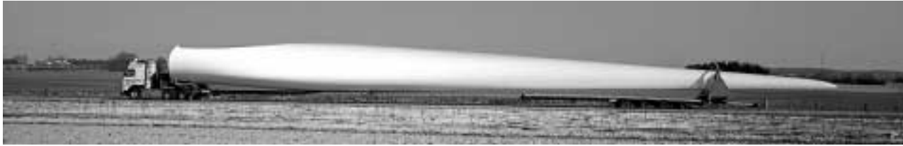
LM 61,5 METER VINGE, maj 2004. Er beregnet til endnu store vindmøller end de i dag anvendte
