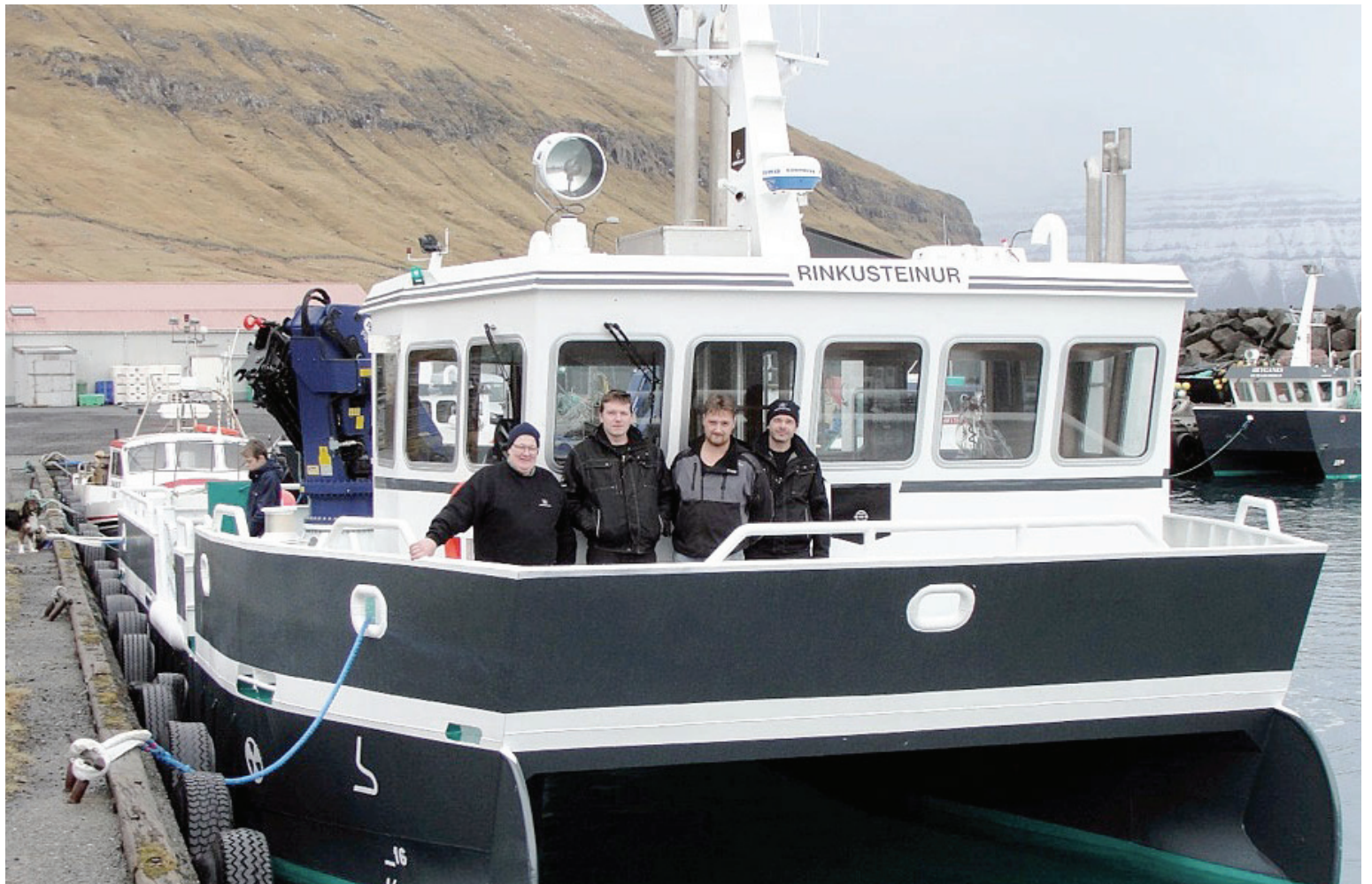
Rinkusteinur er hin størsti alibáturin, sum KJ Hydraulik hevur í sínum konsepti. Hann er 14 metrar langur, sjei metrar breiður og er merktur 25,9 BRT
