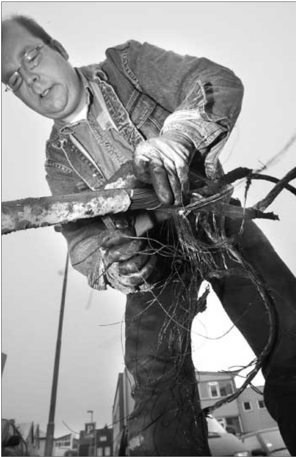
Orsøkin til skammlopið verður hildin at vera vegarbeiðið, sum hevur verið eystanfyrir lögreglustøðina seinastu tveir mánaðirnar. Kaðalin er tá vorðin skamfýlaður, og hesin skaðin elvdi allarhelst til skamlopið mikumorgunin
