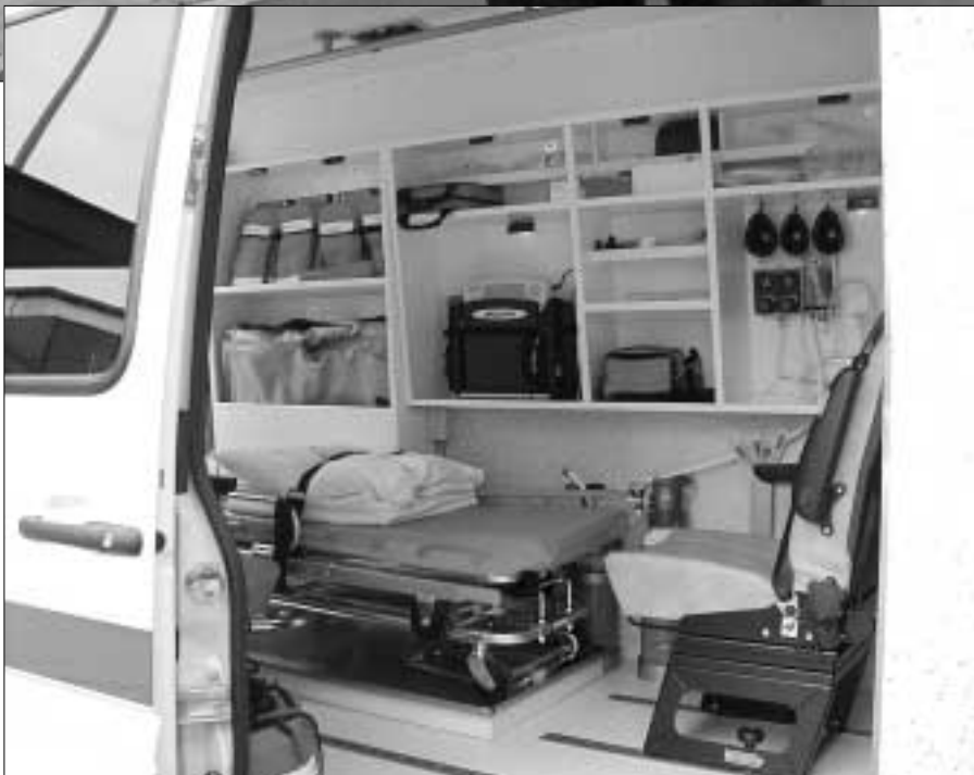
Bilurin hevur alt tað, sum hoyrir til ein nútímans sjúkrabil, skáp og hillar eru gjørd soleiðis, at tað passar til bilin og sær út sum originalt.
