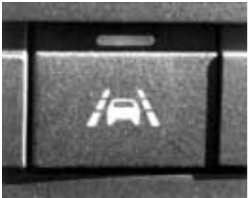
Kontakt til vegstripu alarm
