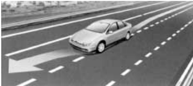
Nýggi Citroën C5 fæst vegstripu-almari, soleiðis at um bilførarin er sovnaður, skuldi hann vakna av vibratiõnununum
