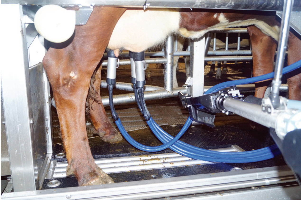
Tólmenni reinsar og setur slangur upp undir boppurnar. Mjólkin rennur so út í tangarnar. Tá ið liðugt er, verður jodað, og kúgvinn sleppur víðari
