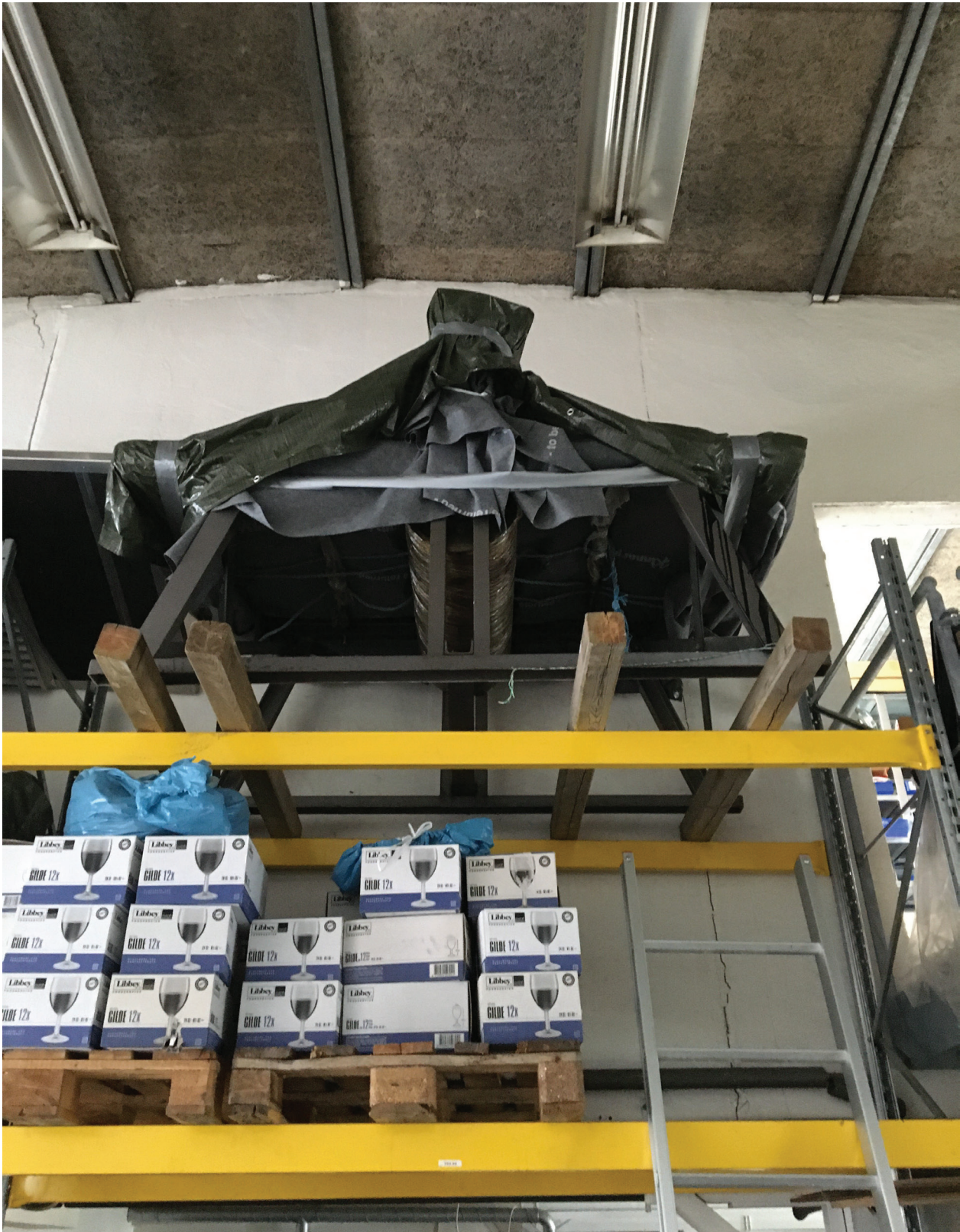
Pressamyndskalbrúkast: Stóra pressan hjá ListGraFo stendur á goymsluhyll á Hjalla. Á myndini sæst, at máling er tornað niður eftir beinunum
