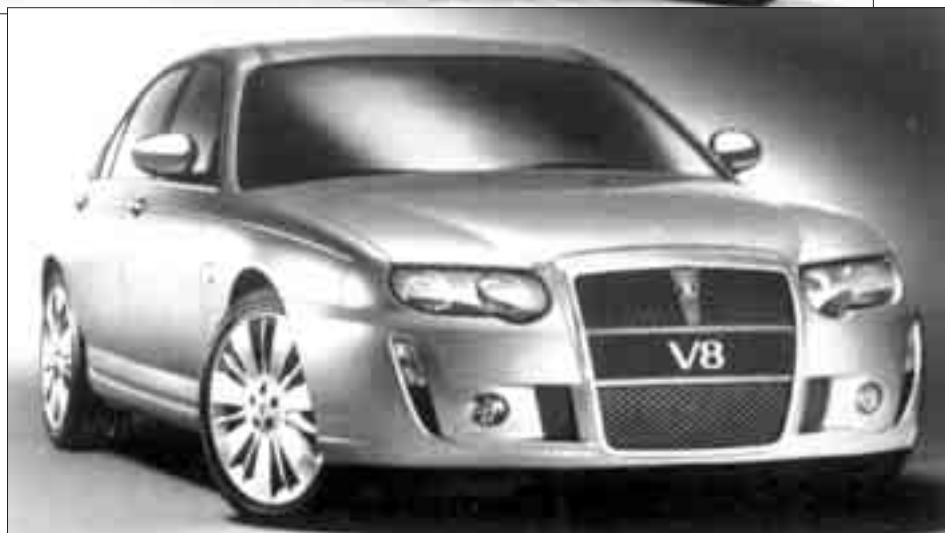
Rover 75 við 4,6 litur V8 motori og 250 hk. Mótvegis øðrum Rover 75 verður hesin drivin av bakhjólunum
