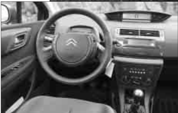
Citroën C4 innan. Undir koyring flytur rattnavið seg ikki, men bert rattkransurin. Luktspreiðari er innbygdur í ventilatiónsskipanina
