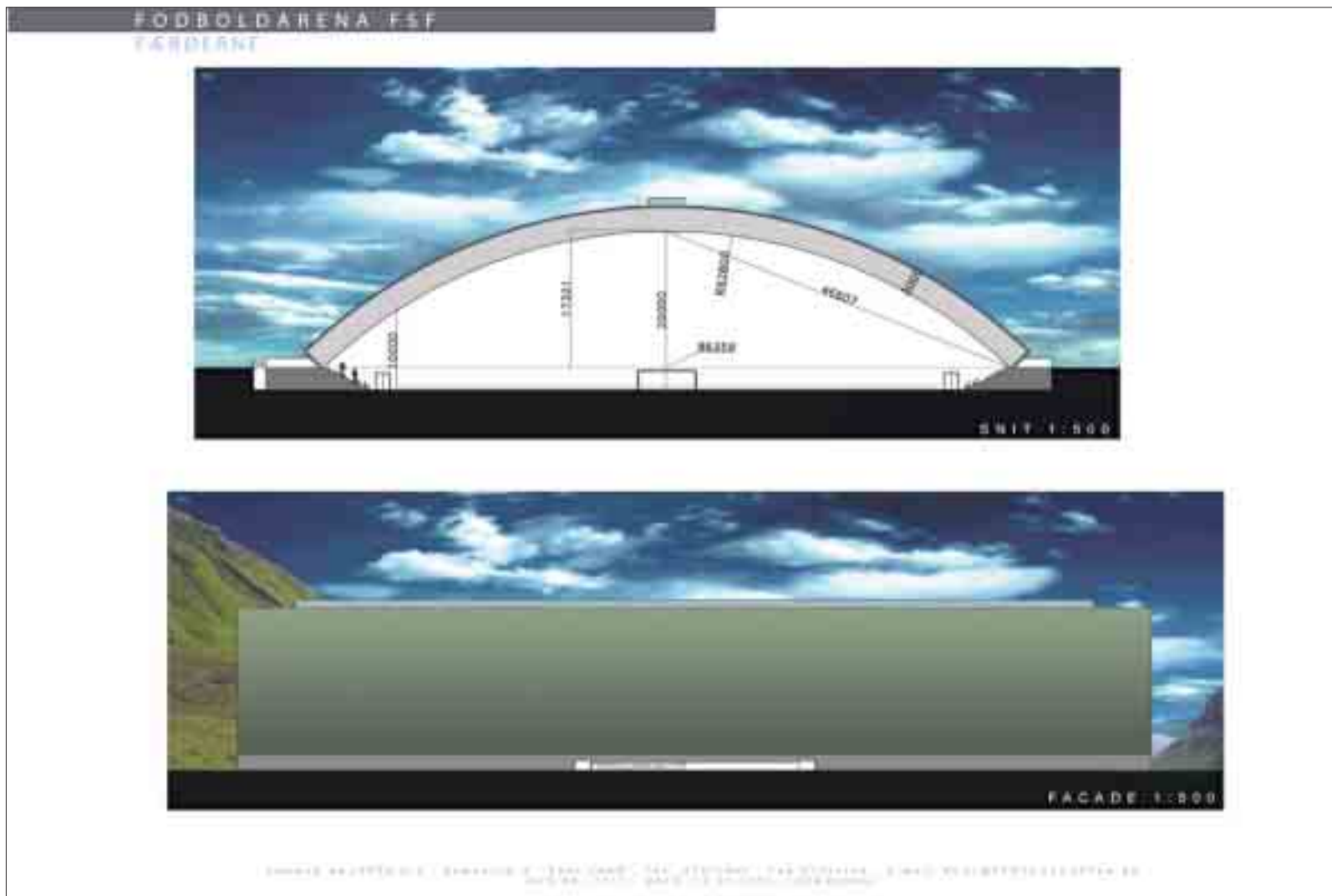
Soleiðis sær nýggja fótبóltshøllin út sambært uppskotinum hjá Havnar Timburhandli. Takið er ein sjálvberandi konstruktión, sum spennir 90 metrar. Hartil er bogin ætlaður til at fáa stóru høllina at fella betri inn í landslagið
