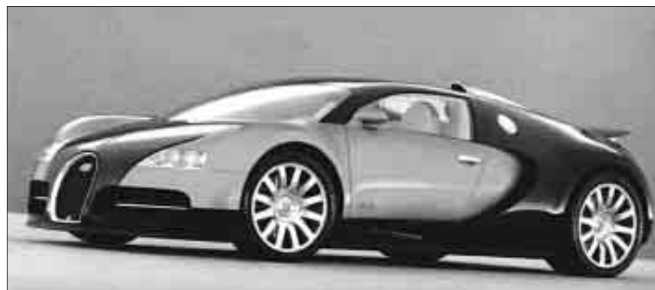
Bugatti Veyron EB 16.4 er 447 cm langur, 2 metrar breiður og 1,2 m høgur. Spoilarin aftan er við til at bremsa bilinum, eins og á einum flogfari
