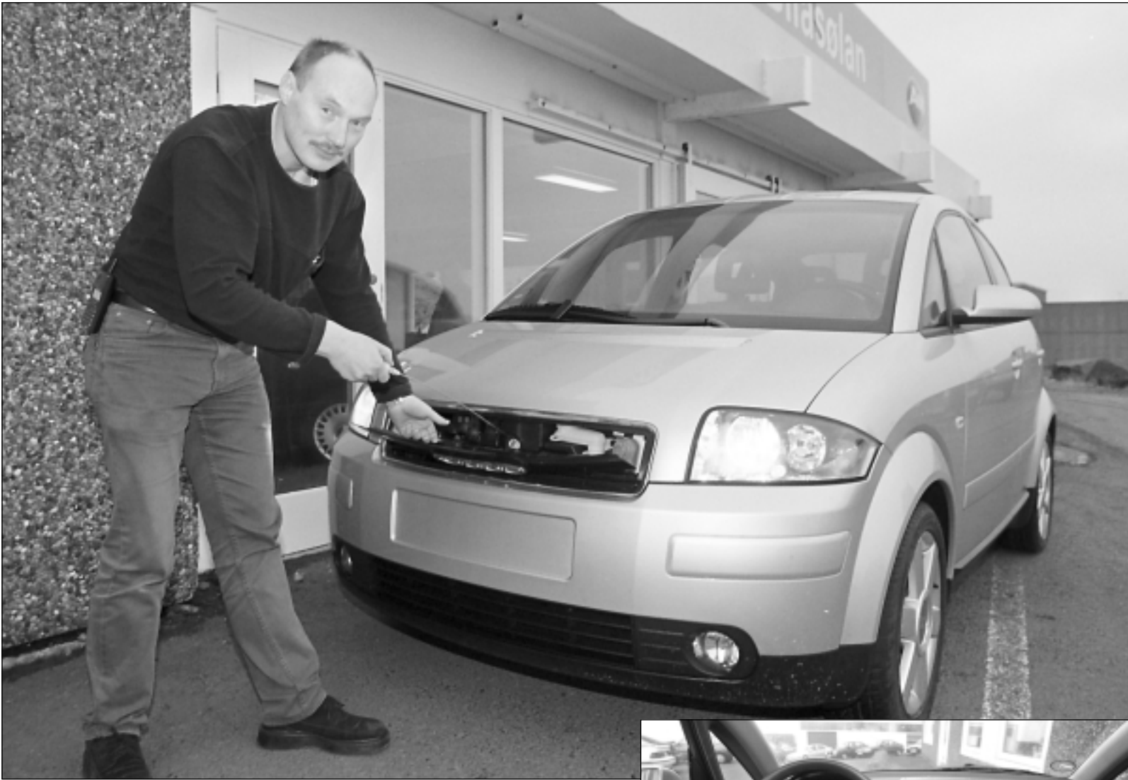
Áfyllingin til olju og sprinklaravesku er frammanfyri, har kølaragittari verður latið upp so sleppast kann til
