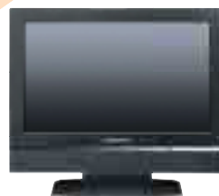
Um Montreal 26" 26" (66 cm) Active Matrix TFT-LCD skermur í 16:9 format. 600 cd/m 2 , kontrast 600:1. 170° sýnsvinkul (horizontal/ vertical). Optisk anti-refleksion og Clear Colour screen coating. 2 Euro-AV (RGB og S-Video). BxHxD (uden stand) 66 x 51 x 10 cm BxHxD (med stand) 66 x 57 x 25 cm.
