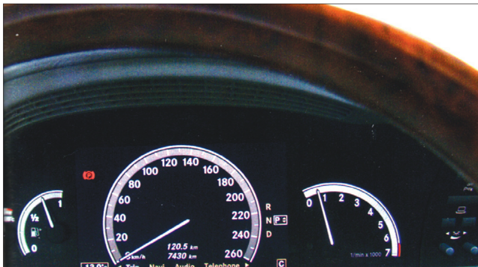
Í dagsljósi sæst tað ikki, at speedometrið er ein skíggi, sum skiftir automatiskt til eina mynd, tá tað verður myrkt
