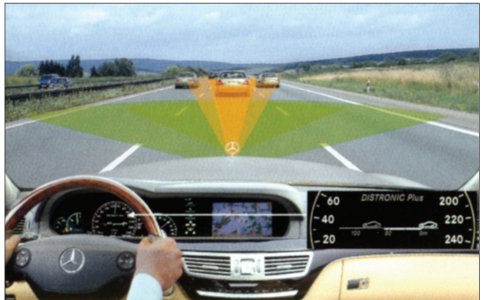
Nýggjasta S-klassanum hjá Mercedes-Benz hevur eina skipan við einum radara sum boðar frá um ein samanstoytur nærkast
