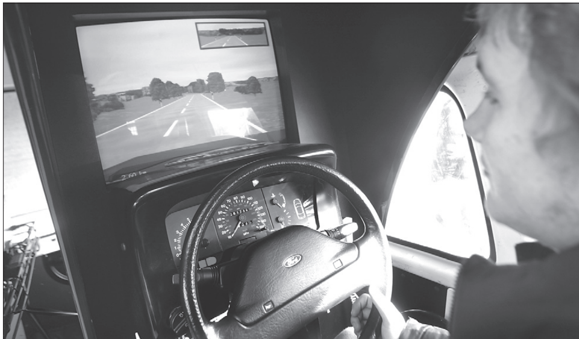
Tað er sum at seta seg inn í ein vanligan bil við instrumentborði, bakki-spegli, startlykli, bremsupedal og spitara. Forrúturin er ein telduskíggi við bakki-spegli
