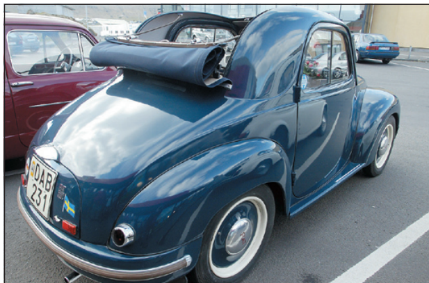
Stoff-galesjan kann rullast afturav. Eykahjólið er innan fyri nummarplátuna, og uttaná er eingin lúka er til viðførissrúmið
