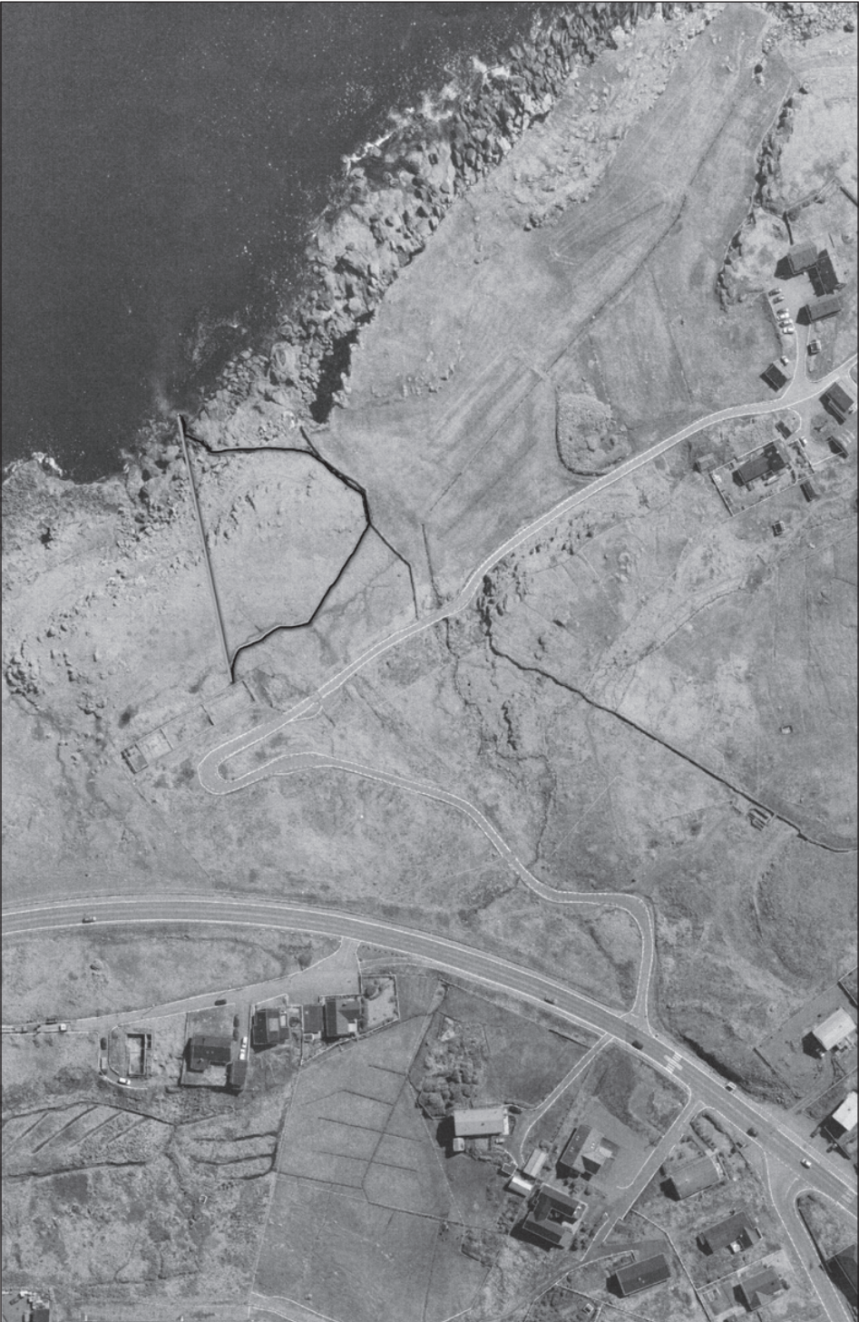
Sum nú er eftirlíkar kloakkin í Kúrdali ikki heilsukrøvini. Hon rennur beint út á sjógv, og tað bæði luktar og sæst. Á myndini síggja vit bæði núverandi kloakkina (svarta strikan) og nýggju kloakkleiðina (hvíta strikan)
