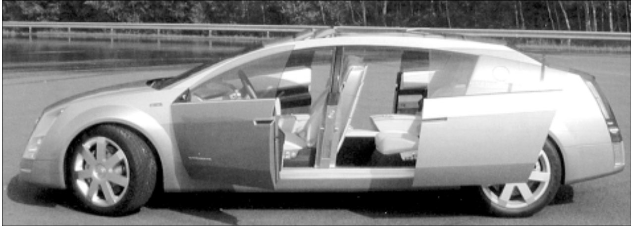
Hurðarnar verða drivnar av elektromotorum. Aftara hurðin fer aftur við síðuni, so tað verður lættari at koma inn í bilin
