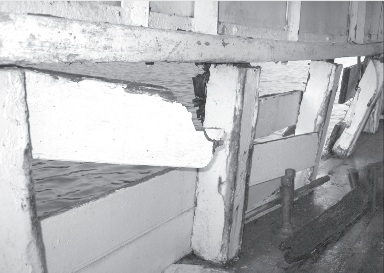
Nakrir stólpar og ein partur av uppstandinum í bakborðssíðu först, tá sjógvurin rakti, og Sjóberin fór at leka
