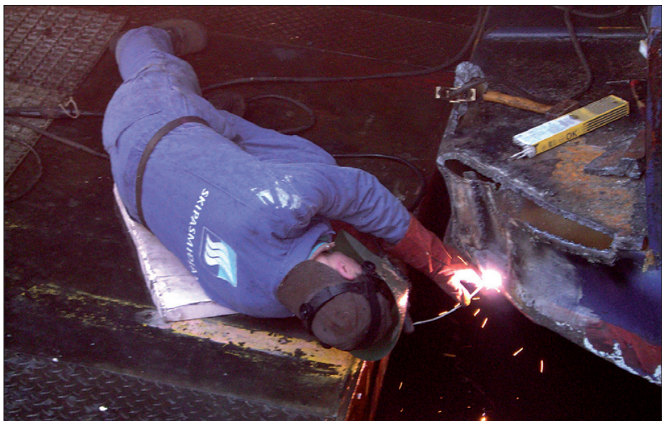
Holið í hekkuni sær ógvusligt út á myndini. So ógvusligt var tað kortini ikki í veruleikanum: Teir hava tikið eitt petti úr, fyri at kunna seta eina nýggja plátu í ístaðin fyri
