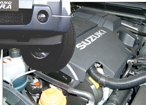
1,9 litur turbo dieselmotorurin við 129 hk og snúningsmomenti upp á 300 Nm.
