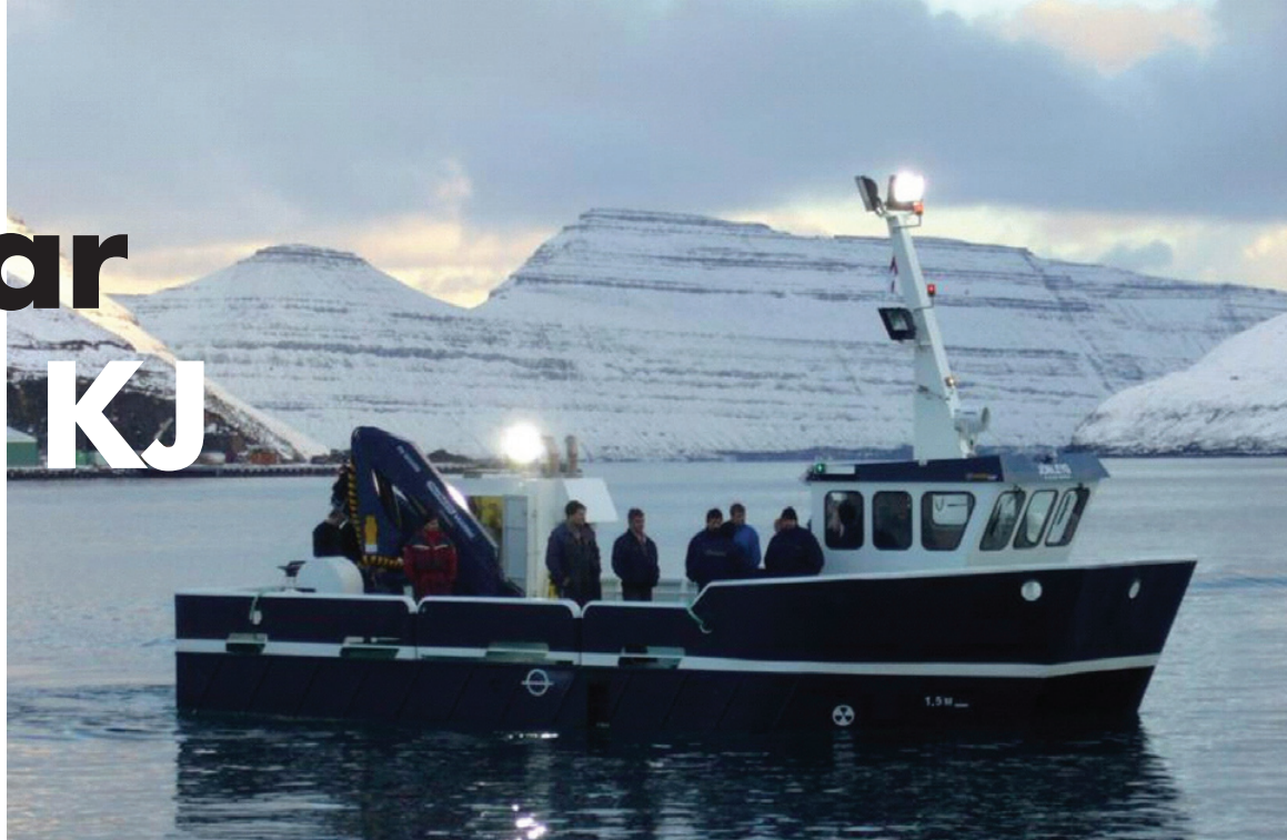
Tvíkiljurnar eru sterkar og rúmligar, eins og útbúnaðurin umborð er tilsvarandi til dygdar. Skrokkarnir eru smíðaðir úr stáli, og húsið er úr aluminium
