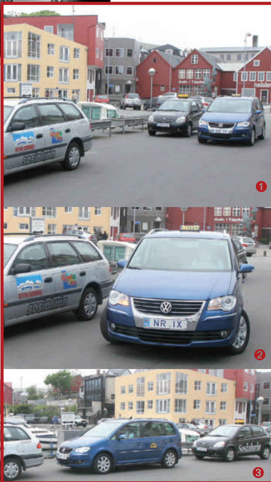
Mynd 1. Bilurin koyrir framvið og skannar báðar bilarnar, hann skal parkera ímillum. Mynd 2. Nú parkerar bilurin sjálvur. Mynd 3. Bilurin er komin upp á pláss
