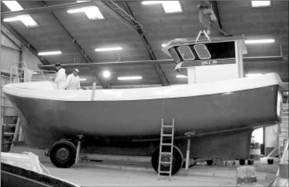
Tann fyrsti báturin av 39 fót slagnum frá AWI verður latin grønendingum í næstum. Húsið skal flytast fram á dekkið, sum verður hált innilokað, eins og kokkahúsið eisini verður flutt úr lugarinum út á dekkið
